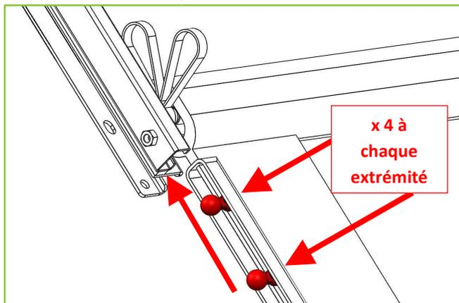
**Remarque** – Les barrières latérales SDR-0-FL4-500 disposent d'un piston de verrouillage supplémentaire à la base du support. Tirez sur ce piston pour déplacer les barres vers le haut de la glissière.
