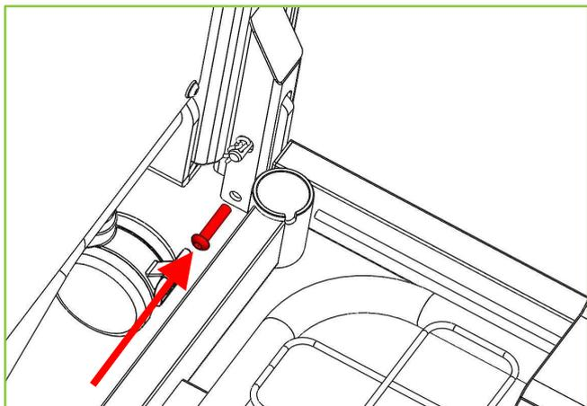
11. Alignez les trous de la partie incurvée du support avec les trous de la barre transversale.
