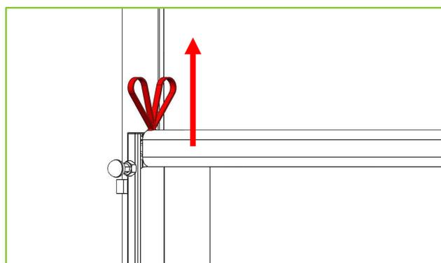
2. Rétractez le piston de verrouillage
