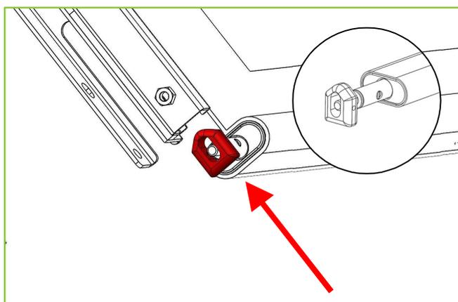
22. Montez la vis de fixation de la barre inférieure (25 mm de long) à l'aide d'une clé Allen de 5 mm.
