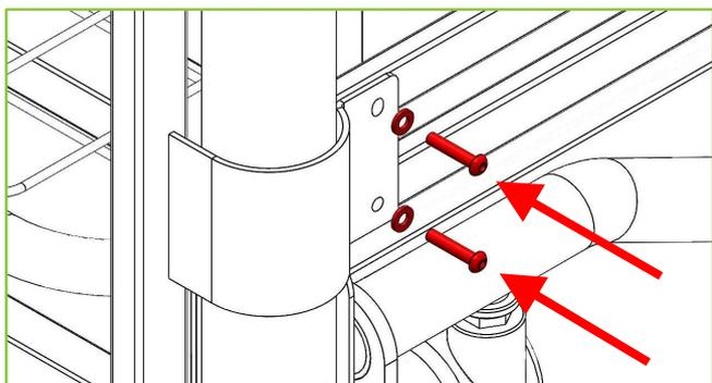
13. Ce support est maintenant en place. Répétez le processus ci-dessus pour installer un support de barrières latérales sur le côté droit du lit du côté tête.
