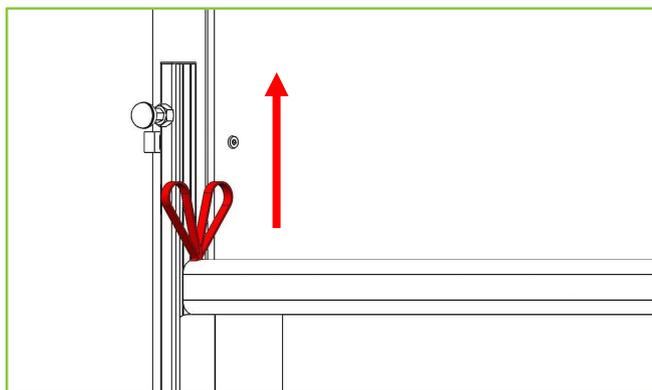
2. Fixez la barre supérieure en place à l'aide du piston de verrouillage. (Vous pouvez rétracter le piston, soulever les barrières latérales, puis relâcher le piston pour verrouiller les barrières latérales en position levée)
