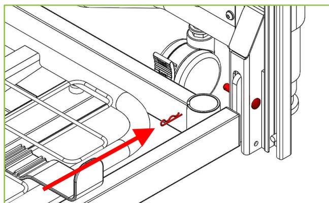
10. Montez la vis de fixation du support (35 mm de long) à l'aide d'une clé Allen de 5 mm.
