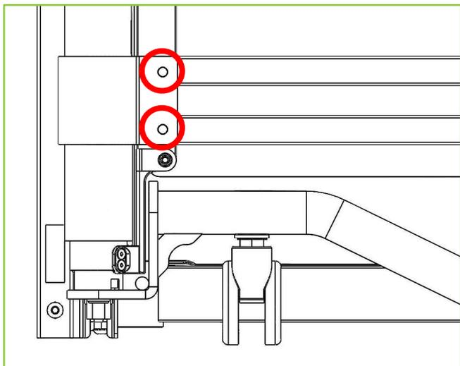
12. Fixez la partie incurvée du support à la barre transversale à l'aide d'une clé Allen de 4 mm et des boulons et écrous retirés à l'étape 4.
