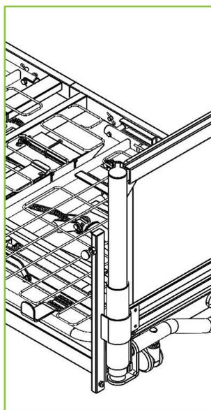
8. Alignez le trou de la goupille de verrouillage des barrières latérales et le trou de la goupille de verrouillage du sommier.
